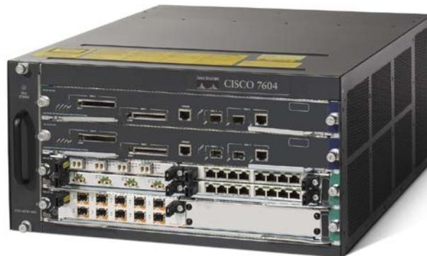
**Brouters**.- Es un dispositivo de interconexión de redes de computadores que funciona como un bridge (puente de red) y como un enrutador. Un brouter puede ser configurado para actuar como bridge para parte del tráfico de red, y como enrutador para el resto.
