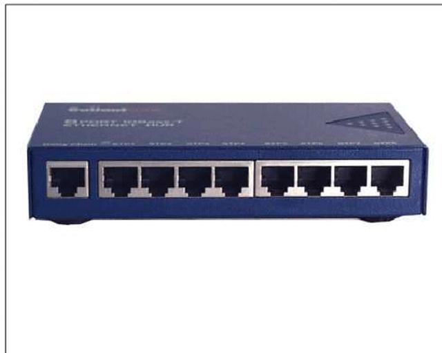
**Switch.**- Es un dispositivo digital de lógica de interconexión de redes de computadores que opera en la capa 2 (nivel de enlace de datos) del modelo OSI. Su función es interconectar dos o más segmentos de red, de manera similar a los puentes (bridges), pasando datos de un segmento a otro de acuerdo con la dirección MAC de destino de las tramas en la red.
